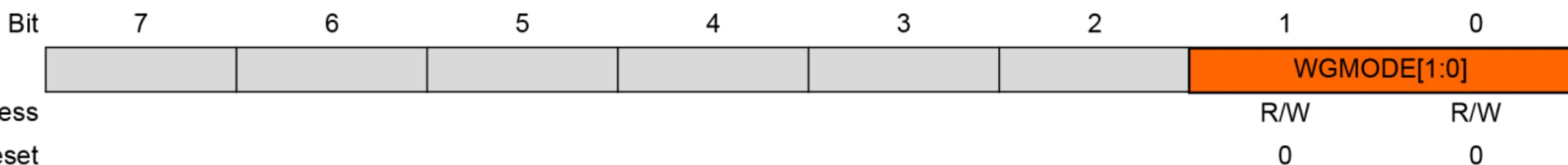
**bits 1:0 WGMODE[1:0]:** Waveform Generation Mode bits
